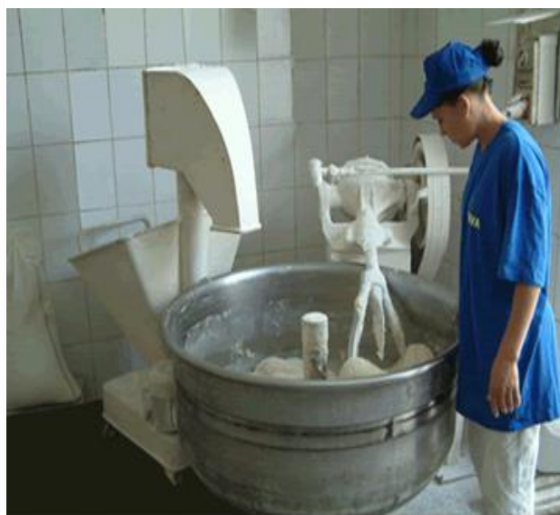
Fig. 4.3. Malaxor spiral cu cuvă mobilă Fig. 4.4. Malaxor cu funcționare discontinuă
